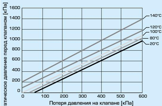
Максимальные потери давления на клапане, ведущие к возможности появления эффекта кавитации. Это зависит от входного давления на клапане и температуры воды.
