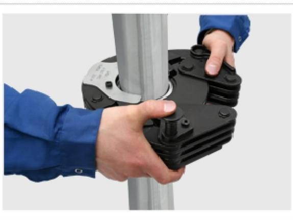
6.4. Пресс должен быть подключен к пресс-клещам, как показано на фото. Обязательно нужно проследить, чтобы зажимающие рычаги пресса были до упора вставлены в пресс-клещи. Граница максимальной вставки отмечена стрелкой на рычагах. Подключенный пресс можно запускать для выполнения опрессовки (обжима) соединения.
